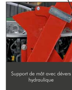
Support de mât avec dévers hydraulique
