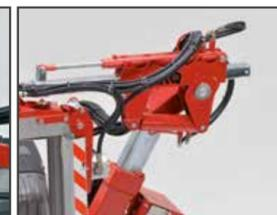
Déport hydraulique, 400 mm
